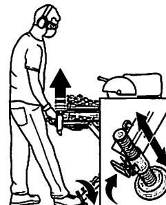
La machine peut aussi être utilisée sans pieds de châssis ou placée sur un établi.
